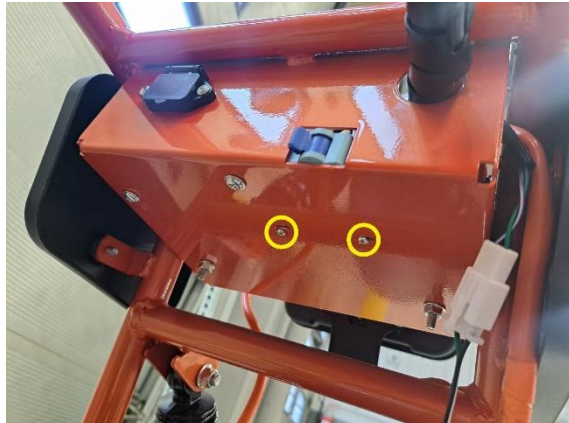
Irrota päävirtakytkimen kiinnitysruuvit (ristipäämeisseli ph2).
